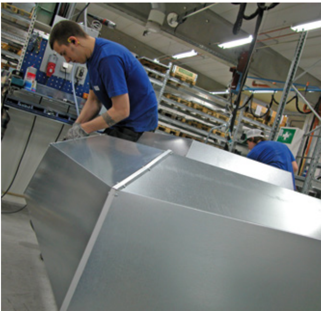
Montering av avluftshuv BRFH i fabriken i Motala.
