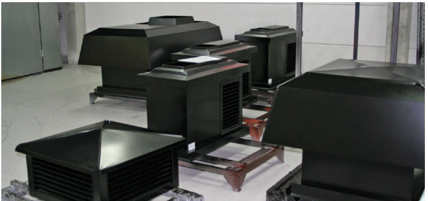
Takhuvar som nyligen pulverlackerats i korrosivitetsklass C4 och härdats i vår värmeugn.
